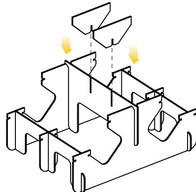
**4** Colocar las dos piezas **F** abrazando la estructura de las piezas **A** y **B**.
