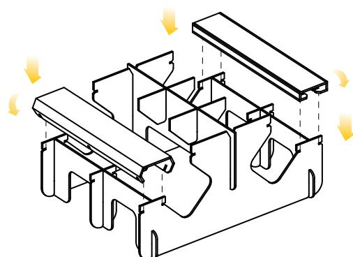
**5** Colocar la pieza **G** abrazando la estructura de las piezas **A** y **E**.
